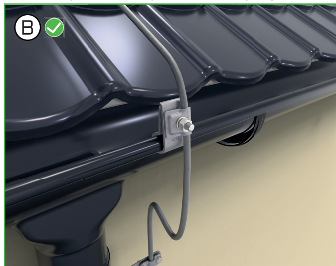
przewodzenie przewodu nad rynną
